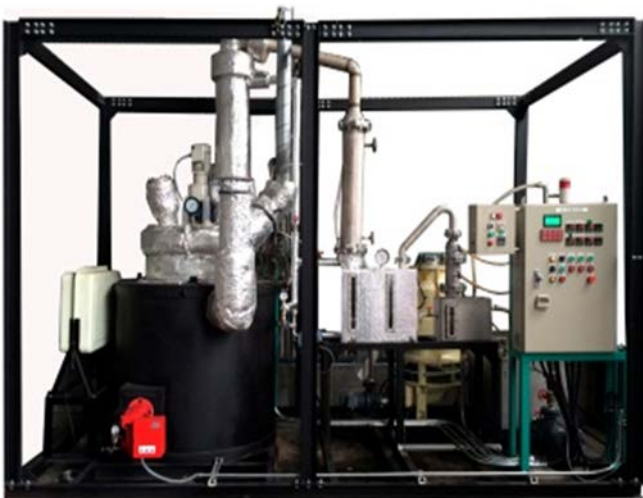
(写真：油化装置)
